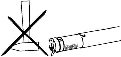
Enfoncer le moteur dans l'axe, ne pas frapper au marteau!
