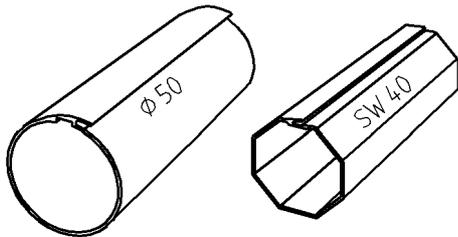
Utilisez les axes de montage rapide SIRAL pour les mini-volets
