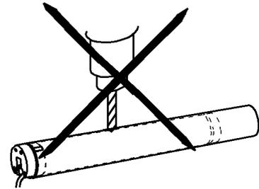
Ne jamais percer de trous dans la zone du moteur tubulaire!
