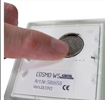
Neue Batterie (Typ CR2032, 3V) so einsetzen, dass die Beschriftung sichtbar ist.
