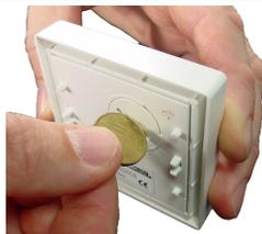
Steuerteil vom Rahmen abziehen und Batteriedeckel mit einer Münze öffnen.
