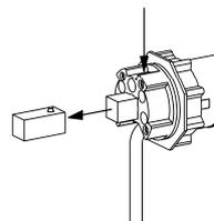
Zum Ausbau des Vierkants wird mit einem Stift der Arretierbolzen zurückgedrückt und der Vierkant herausgezogen.
