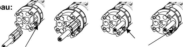
Exzentrerscheibe muss nach rechts gedreht sein, Stecker bis zum Anschlag einschieben, Exzentrerscheibe nach links drehen und Klemmschraube festziehen.
