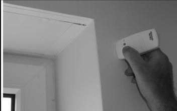
Sender in die Nähe des Netzanschlusskabels halten, an dem das SF19 angeschlossen ist.
