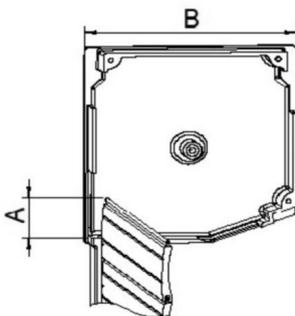
Der oberste Profilstab des Rolladens sollte nicht mehr als 1/2 der Profilhöhe aus der Führungsschiene herauskommen (A).
