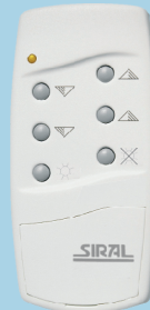
6-Kanal Handsender mit Sonderfunktion 580627
